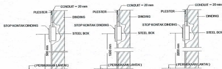
PEMASANGAN STOP KONTAK
