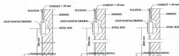
PEMASANGAN STOP KONTAK
